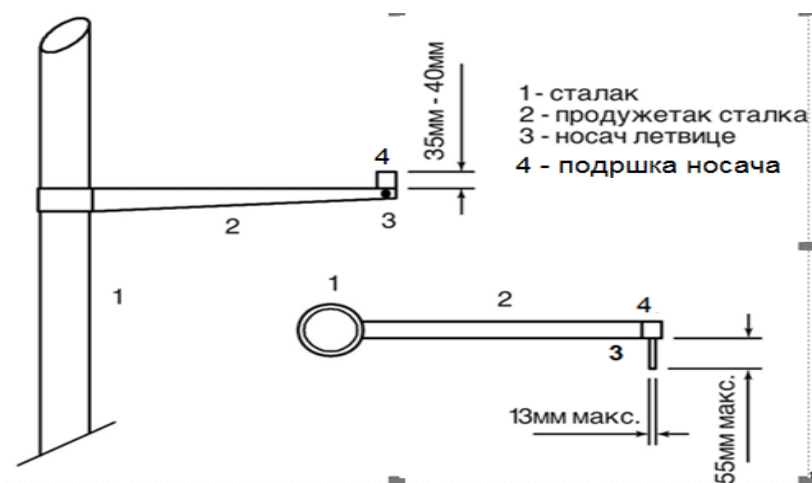
Скица 8 - Сталци за скок мотком (изглед са доскочишта и изглед одозго)
